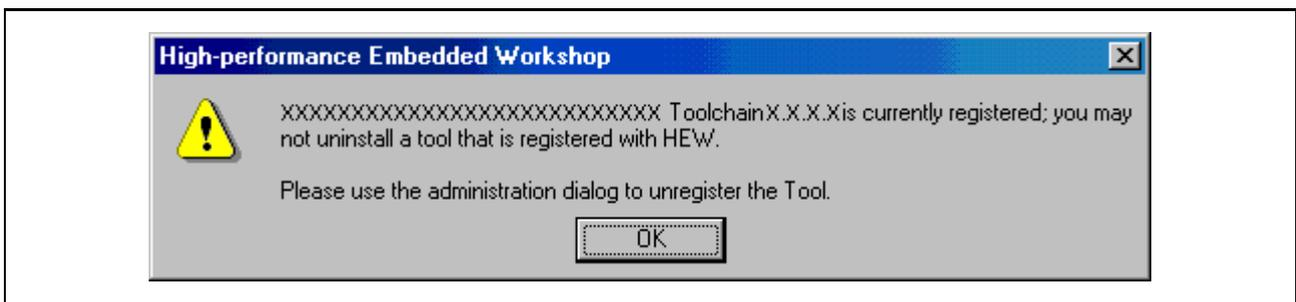
这样，必须返回到 [Tools Administration] (工具管理) 对话框 (通过选择 [Tools] (工具) → [Administration] (管理) 来存取)，撤消对工具的注册，然后再次调用 [Tool Uninstaller] (工具卸载程序)。
