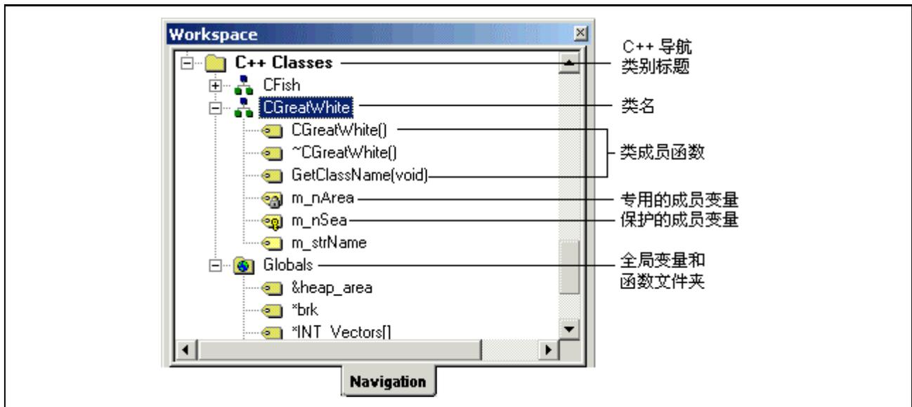
C++ 导航视图使用了许多图标来描述图标所属的函数或变量的类型。这些内容在下表中列出：
