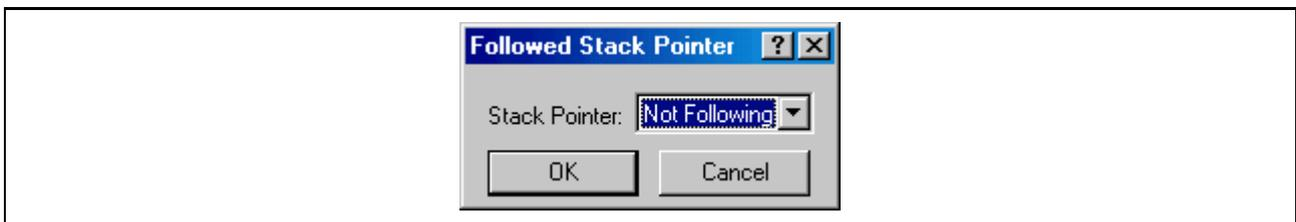
从下拉式列表中选择要跟踪的堆栈指针。通过跟踪选定的堆栈指针位置, [Memory] (存储器) 窗口的显示地址将自动改变。在 [Followed Stack Pointer] (随后的堆栈指针) 对话框中选择 “Not Following” (不跟随), 将使调试器停止跟踪堆栈指针位置。
