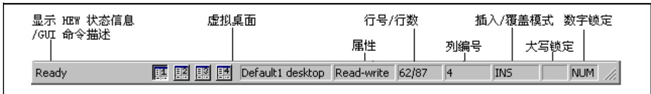
使用可自定义的状态栏功能，用户可以自定义状态栏区域及其内容的显示。现在，状态栏还可以根据所用特定目标的需要，显示与目标有关的信息。
