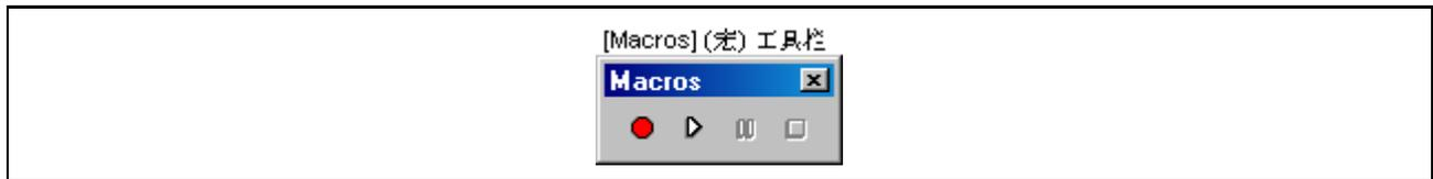
若 [Macros]（宏）工具栏已隐藏，请选择 [Setup]（设置）→ [Customize]（自定义）打开 [Customize]（自定义）对话框。选中 [Customize]（自定义）对话框的 [Toolbars]（工具栏）选项卡上的 [Macros]（宏）复选框。
