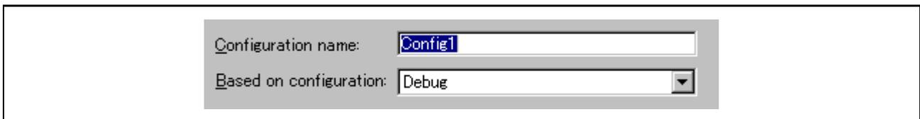
4. 从 [Based on configuration] (基于配置) 下拉式列表选择一个现有的创建配置, 将其作为新的创建配置的基准。
