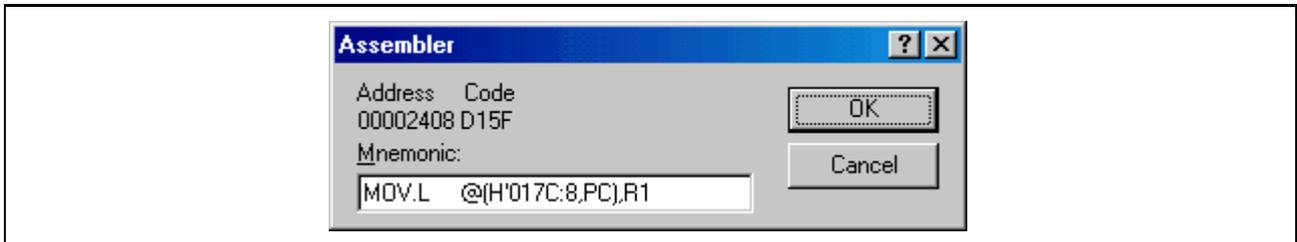
将会显示地址、机器码和反汇编的指令。在 [Mnemonic]（助记码）字段中键入新指令或编辑旧指令。如果按 Enter 键，则系统会将该指令汇编入存储器，然后移至下一条指令。如果单击 [OK]（确定）按钮，则会将该指令汇编入存储器，然后关闭该对话框。如果单击 [Cancel]（取消）按钮或按 Esc，则将关闭该对话框。
